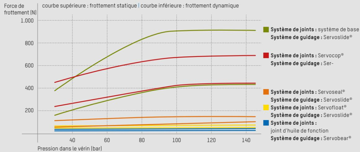
Valeurs mesurées sur le vérin double tige (alésage 46 mm sans joint, Ø tige 40 mm) en régime sinusoïdal selon VDMA 24577 à 50 °C/HLPD46. Les courbes de force de frottement sont au-dessous du niveau standard.
