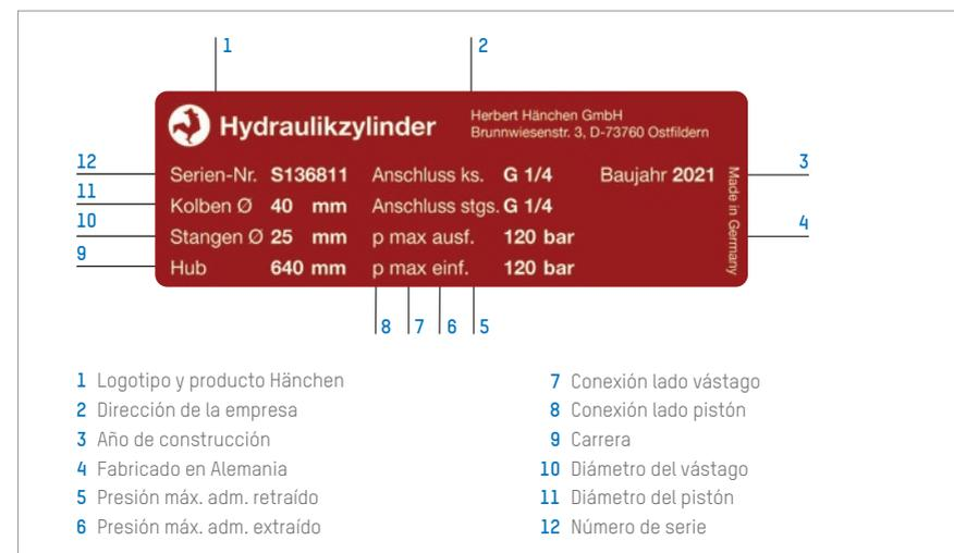
Figura 1: p. ej., Placa de características del cilindro hidráulico
