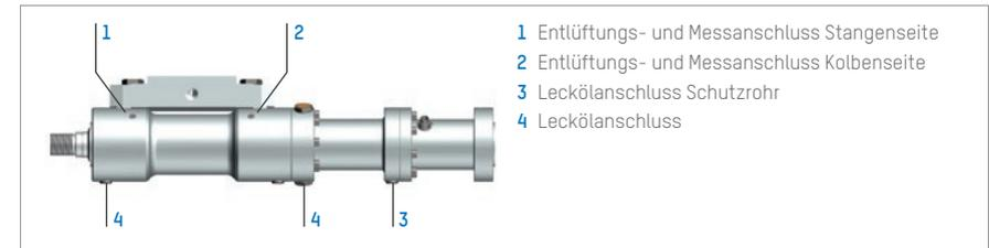
Abbildung 5: Entlüftungs- und Messanschlüsse Zylinder Dichtungssysteme Servocop® oder Servoseal®
