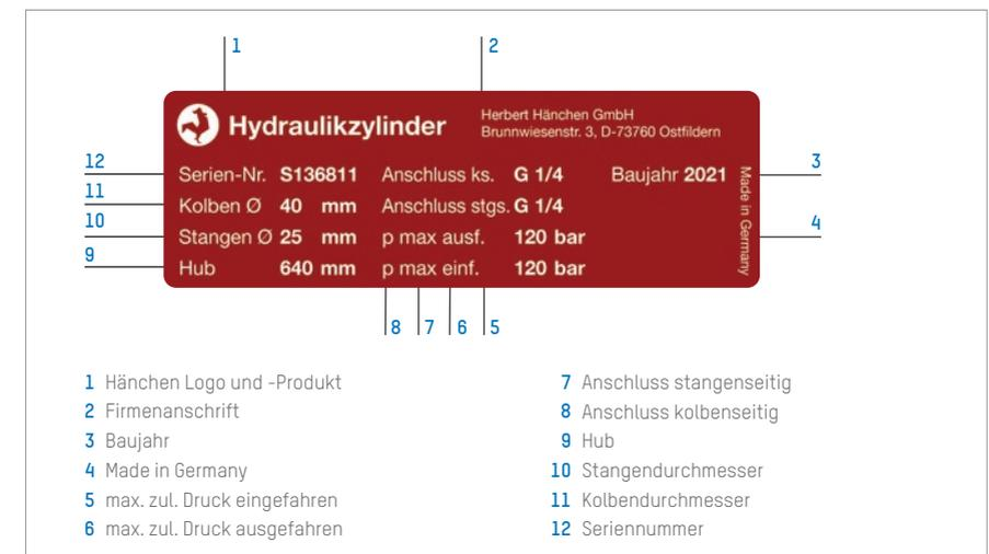
Abbildung 1: Beispiel Typenschild Hydraulikzylinder
