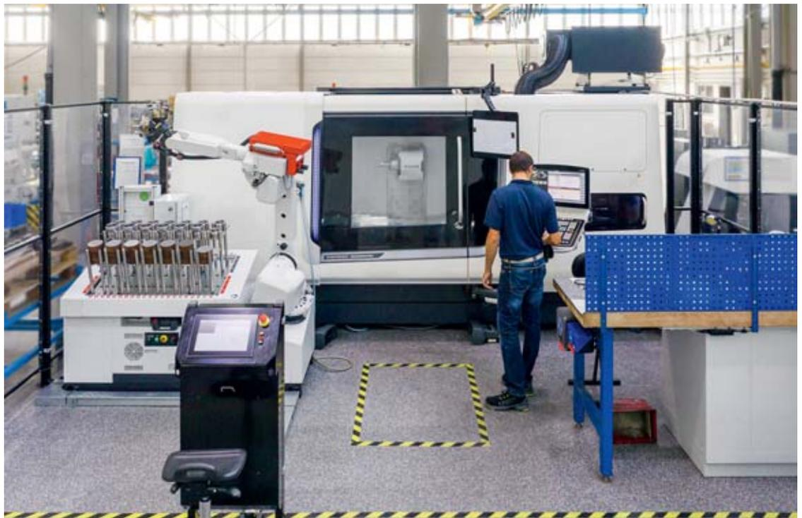
Maschine, Lichtschranke, Schutzzäune, Bedienpult – die Umsetzung eines praktikablen Sicherheitskonzeptes ist immer ein zentraler Baustein der Sondermaschinenbausparte Ratio-Drive von Hänchen.
