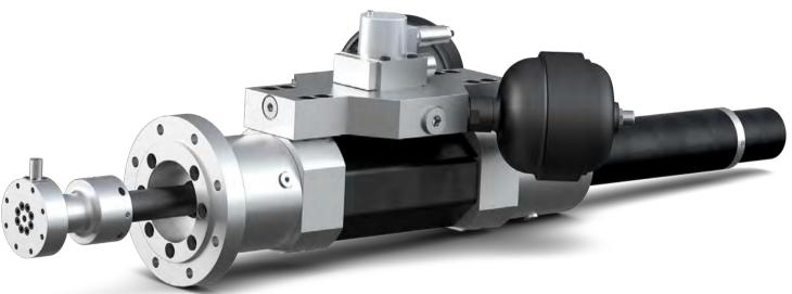
▶ ZIEL DER KONSTRUKTEURE der Herbert Hänchen GmbH war zunächst die Entwicklung einer Leichtbau-Kolbenstange aus Carbon für Kleinstückzahlen. Mit dem gewonnenen Know-how realisiert der Hersteller heute in einem neuen Fertigungsverfahren Zylinderrohre aus H CFK ohne metallisches Innenrohr sowie H-CFK-Kolbenstangen ohne metallische Lauffläche.
