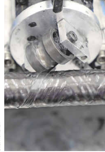
Der Fadenleger bestimmt durch den Winkel die Eigenschaften des Werkstoffverbunds
