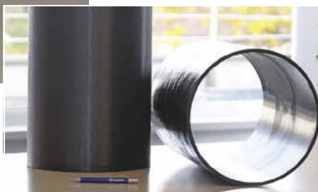
Rollen für einen Fahrzeugprüfstand aus dem neuen Werkstoff-Verbund H-CFK ermöglichen eine deutliche Verringerung der Masse
