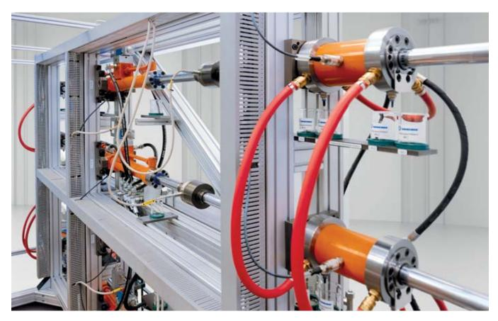
Auf diesem Prüfstand testet das Unternehmen Dichtungen und Führungssysteme. Rild · Hänchen
