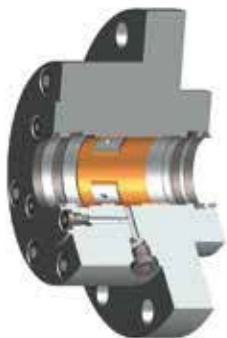
»1 CAD-Zeichnung eines Führungssystems für ein hydrostatisches Lager
