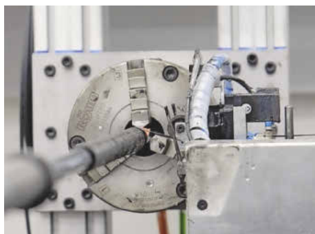
Das Wickelverfahren erfolgt auf einer 7-Achs-Ratio-Drive-Maschine, die es schon bald in einer größeren Ausführung für die Einzel- und Kleinserienfertigung geben wird.
