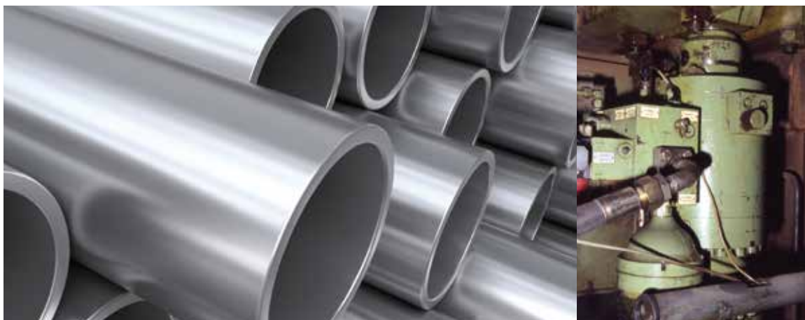
3 | Hydraulik-Zylinder an der Strangguss-Anlage: Oszillation mit drei Hertz verhindert Anhaften des Stahlstrangs an der Kokillinnenwand.
