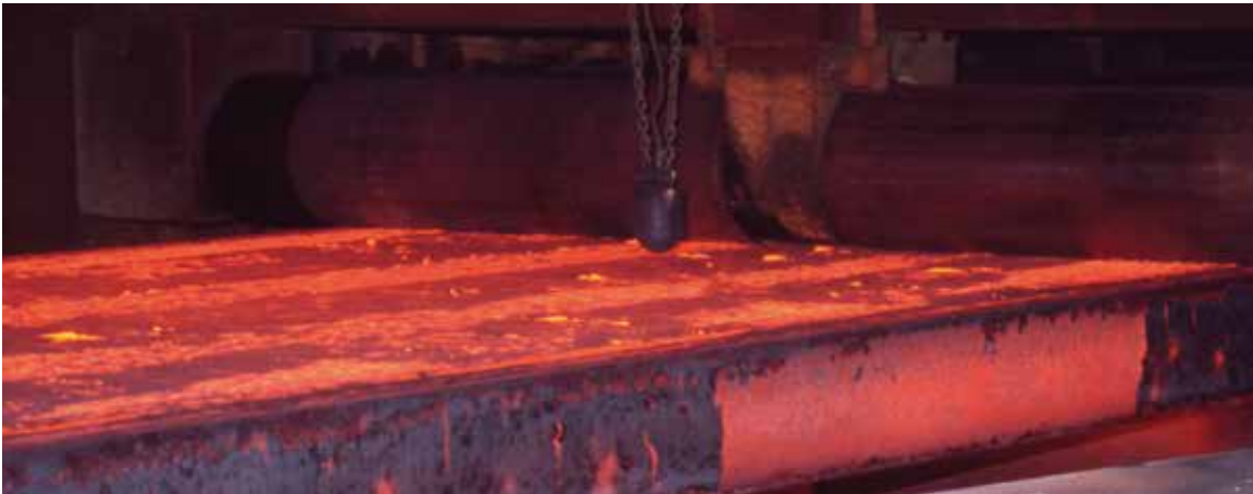
5 | Rotglühende Bramme: „End- produkt“ der Strangguss-Anlage (Detailansicht).
